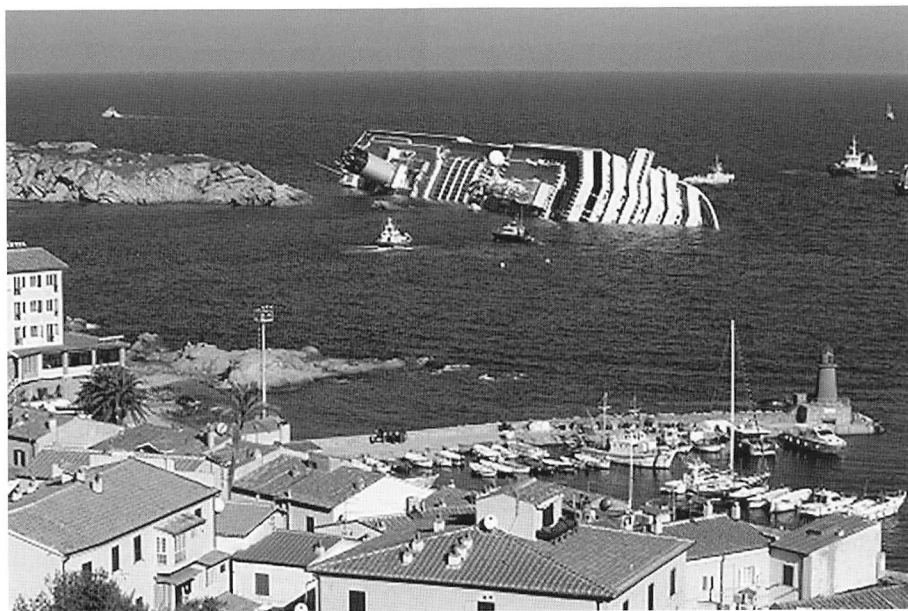
舵を切るタイミングのミスで岩に衝突して沈没した大型クルーズ客船「コスタ・コンコルディア」
